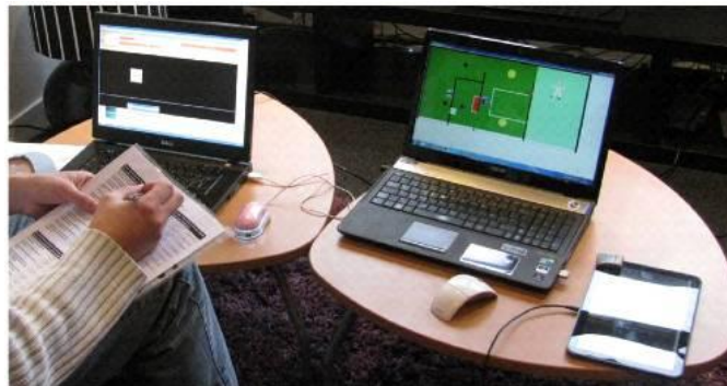
Figure 2. KISS expérimental. Sur la table de gauche, le laptop sur lequel s'exécute l'éditeur de programmes. Sur la table de droite, le laptop du metteur au point et sa tablette pour jouer sur le temps.
