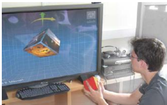
Figure 11. CubeTV. L'utilisateur change les chaînes de la télévision grâce au cube qu'il tient dans ses mains. ([Block 04])
