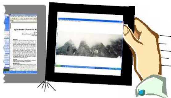
Figure 6. Les tablettes d'Hinckley. Le choc entre deux tablettes entraîne leur assemblage. ([Hinckley 00b])
